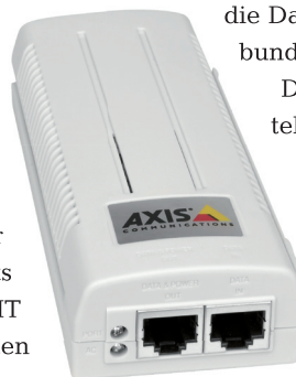
Axis PoE Midspan 1-Port: Versorgt laut Hersteller Ethernet-Kabel der Kategorie 5 (Cat5) mit 48 Volt Gleichstrom über die Adernpaare, durch die keine Daten laufen. (Quelle: Axis Communications)
